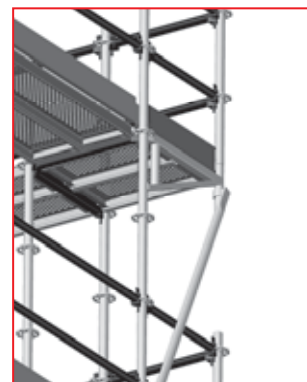
Rys. 3.25 – Narożnik wykonany za pomocą trzech stojaków, wspornika i stężenia (patrz rys. 3.28)
