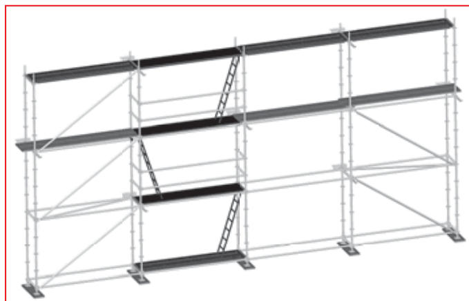
Rys. 3.61 – Pomost roboczy i zabezpieczający wyposażony w stężenia
