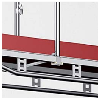
Rys. 84: Szczegół U-rygla podwójnego z łącznikiem rurowym
