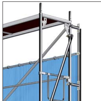
Rys. 118: Przykład zabudowy systemu plandek kederowych z wzmocnieniem
