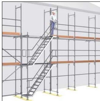
Rys. 54: Montaż poręczy schodów
