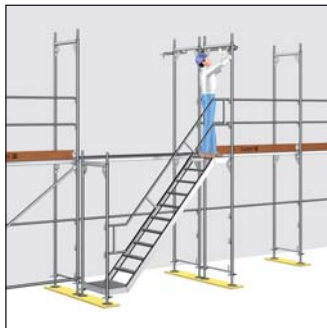
Rys. 53: Połączenie z rusztowaniem głównym
