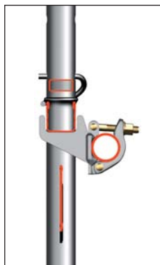
Rys. 41: Przekrój złącza kotwiącego
