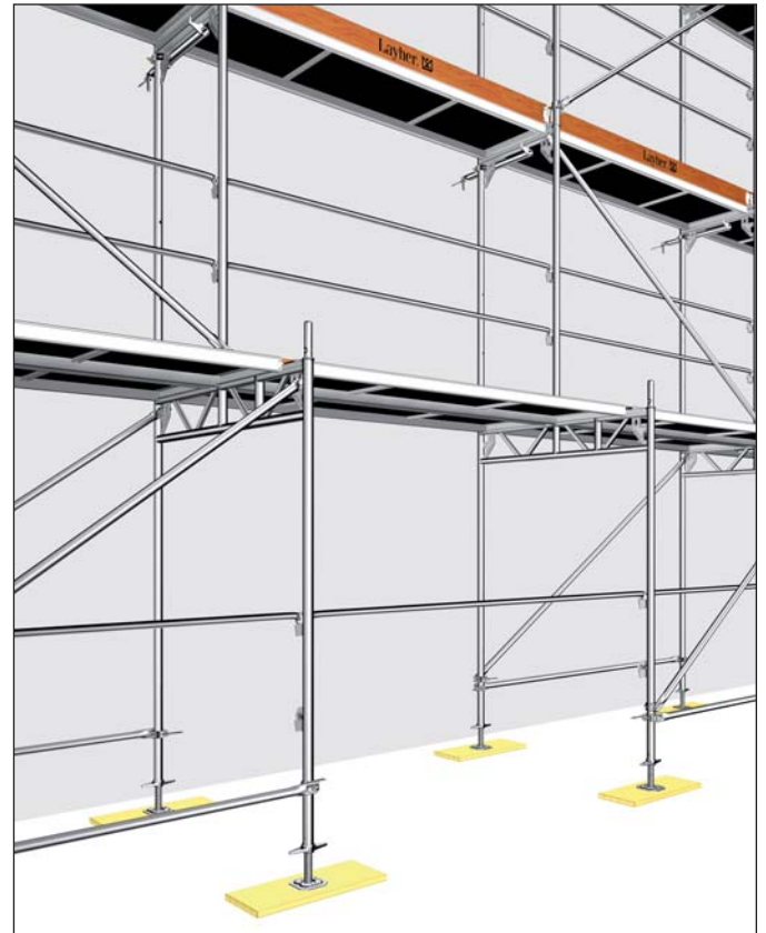
Rys. 93: Montaż ramy przejściowej
